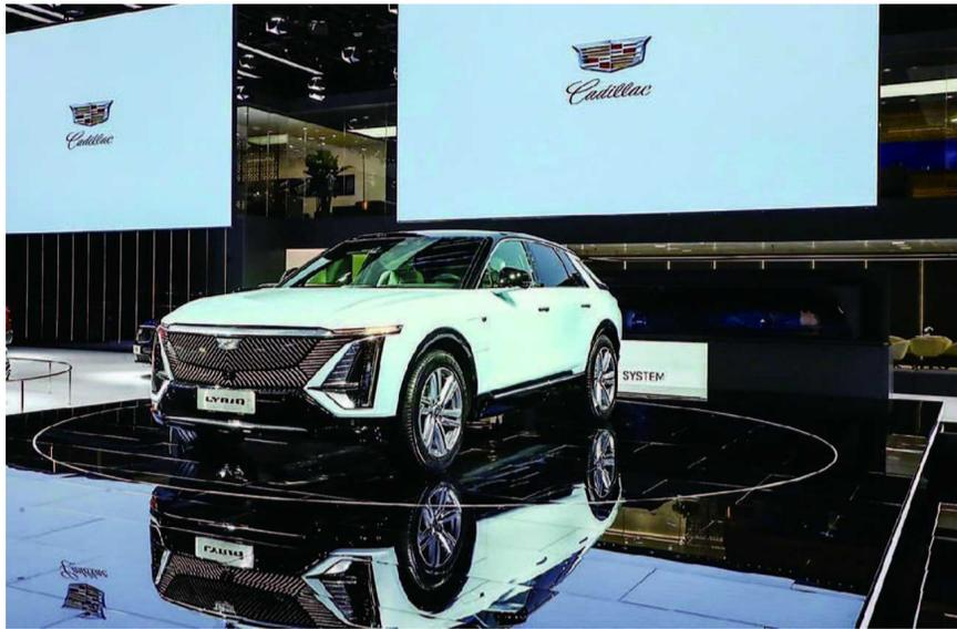
405kW，峰值扭矩为750N·m，零百加速仅需3.7s。据介绍，机甲龙还搭载全球领先的800V/480kW高效补能技术和关联APA无线充电功能，在CLTC标准下，充电10分钟续航401km。
