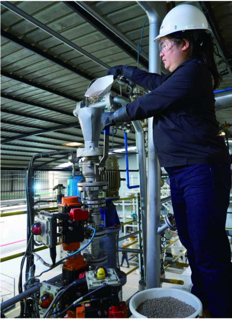
Novoloop联合创始人汪郁雯将塑料废物颗粒装入印度苏拉特试点工厂的料斗。汪郁雯与联合创始人姚佳韵已研究这项技术十年之久。©Rolex/Greg White
