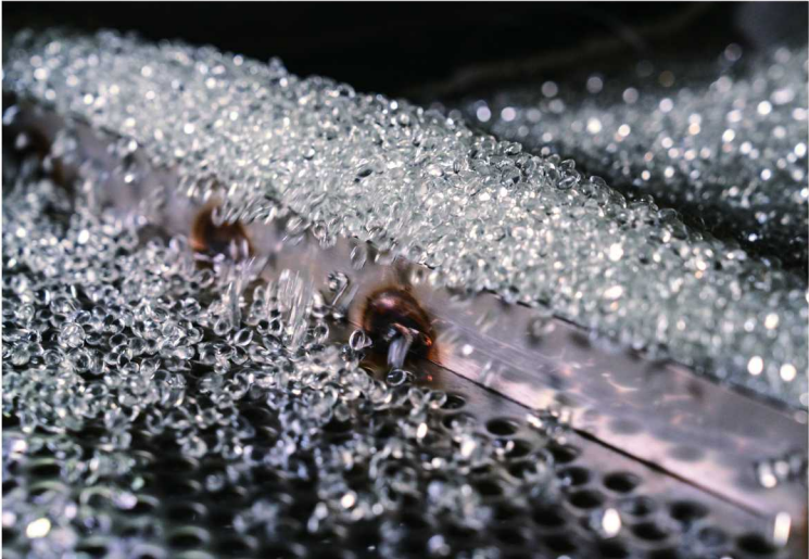
Novoloop联合创始人汪郁雯与姚佳韵致力于实现真正的塑料循环经济。图为合作公司中国温州华峰集团工厂生产线上的Novoloop热塑性聚氨酯（TPU）颗粒。©Rolex/Roman Meisenberg
