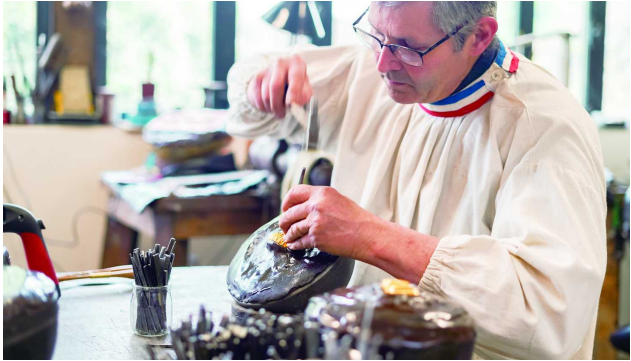
◎将冠饰固定在颀座上并进行锤揲与篆刻加工 摄影：Guillaume Levelu/Guil Photographie
