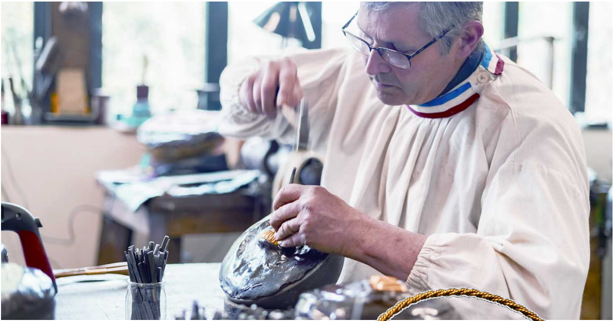
◎将冠饰固定在鑲座上進行鑄鑄與鑲刻加工，攝影 Guillaume Levelu, Guil Photographie
