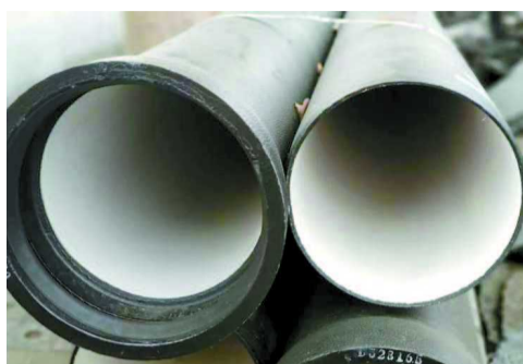
试点工程采用具备高性能“抗腐蚀球墨铸铁管”管材
