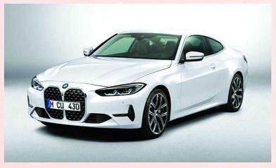
宝马全新一代 4 系比老款长 5.2 英寸（约 132mm），轴距加长 1.6 英寸（约 41mm），宽了一英寸（约 25mm），尽管增加了尺寸和突出的长鼻，4 系列实际上是更明显的空气动力学，从 0.29cd 下降到 0.25。另外，值得一提的是，全新 4 系并没有采用 i4 上的 BMW 扁平化的新车标。
