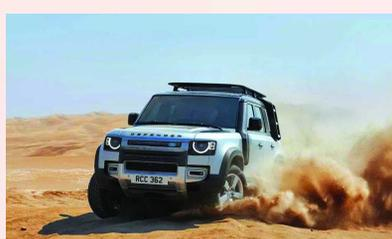
全新一代路虎卫士基于全地形 D7x 架构打造，并使用了承载式车身结构和全铝架构，整体车身重量变得更轻。新车还搭载了路虎第二代全地形适应反馈系统，进一步提升新车的越野性能。
