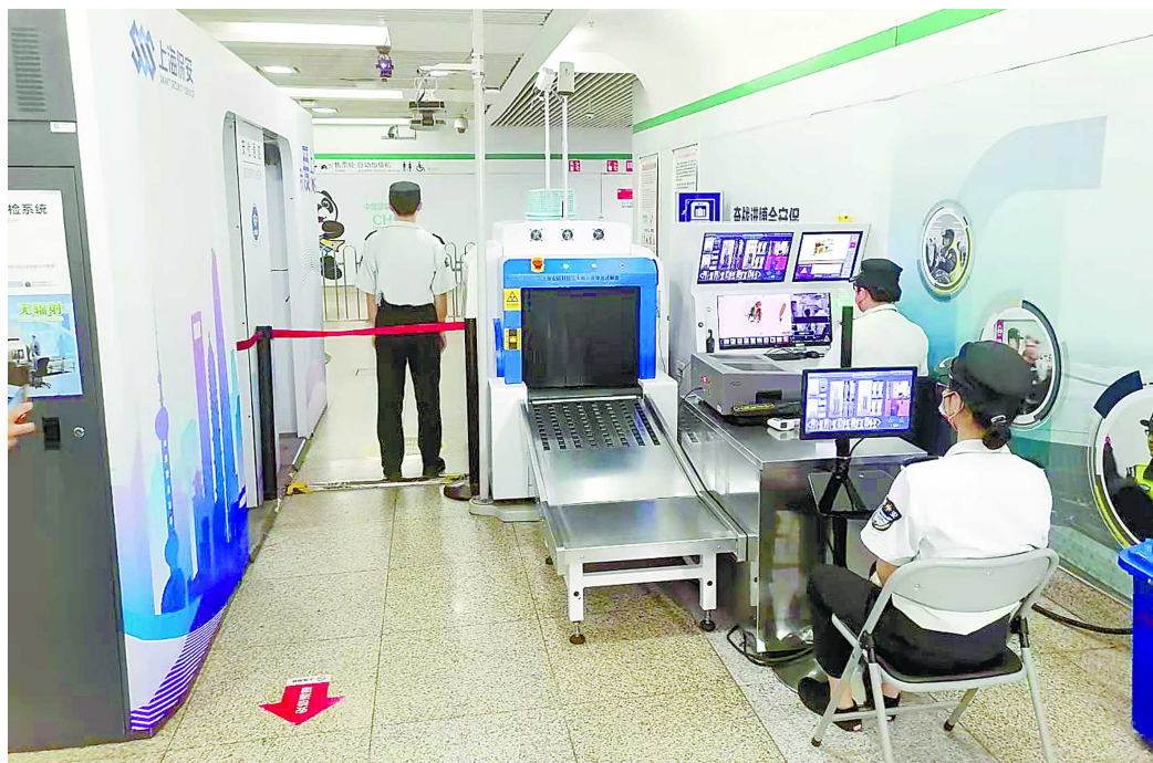
“太赫兹安检”系统看上去像个“小屋子”,安检无需停留,不发出辐射,可保障乘客安全。 /晨报记者 钟晖
