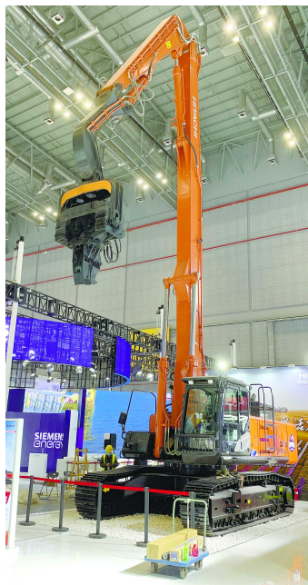
在日立 ABB 电网的展台的这台打桩机 机动臂长度为 12 米
