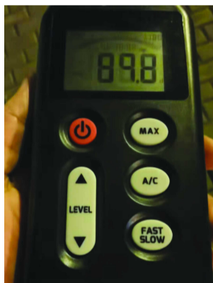
现场噪音音量高达89.8分贝
