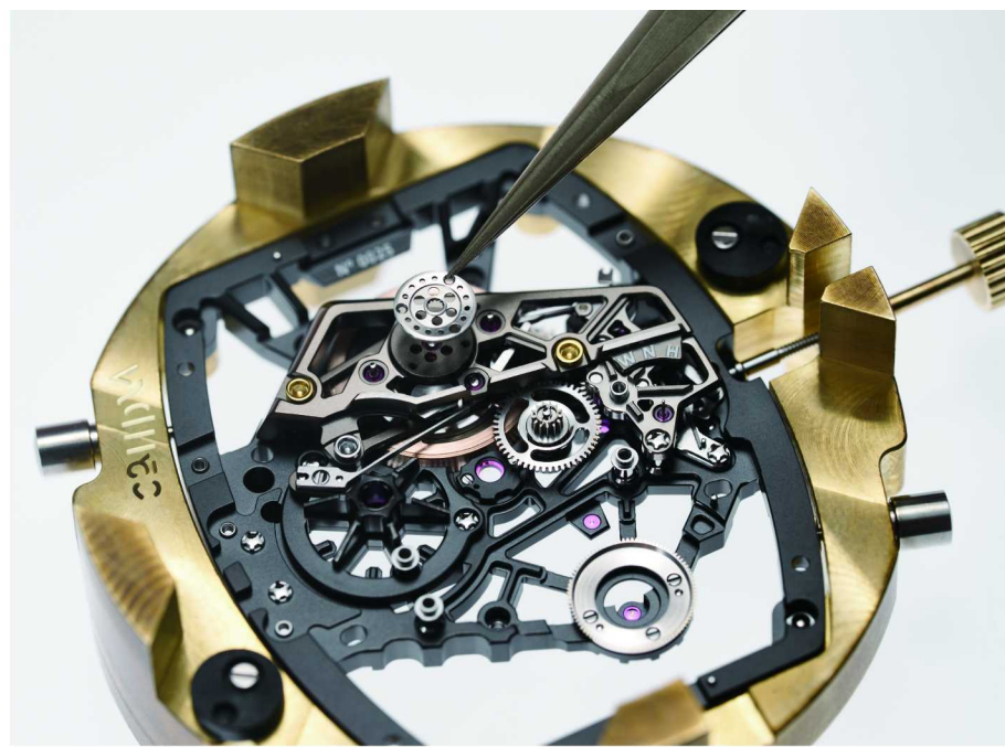
桥板以五级钛合金和Carbon TPT®碳纤维打造
