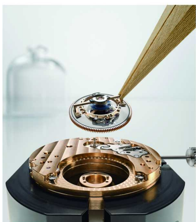
宝玑 Classique 经典系列 7255 天体陀飞轮腕表 - 陀飞轮装置
